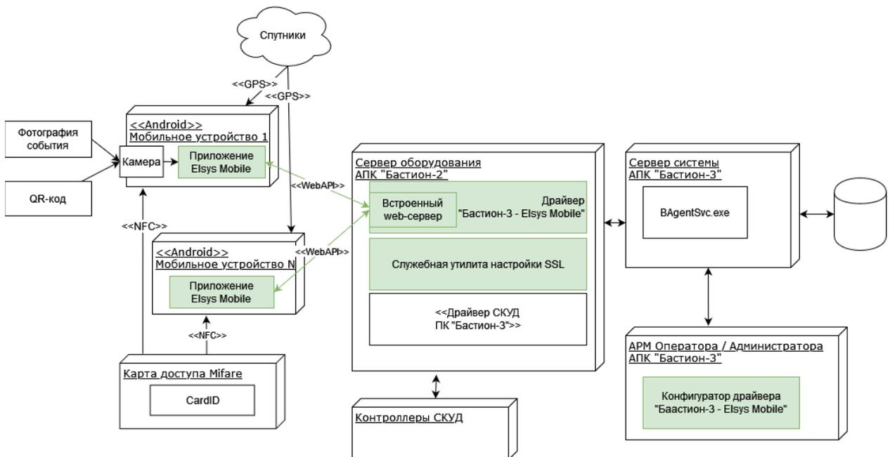
Рис. 1 Структура системы Elsys Mobile
