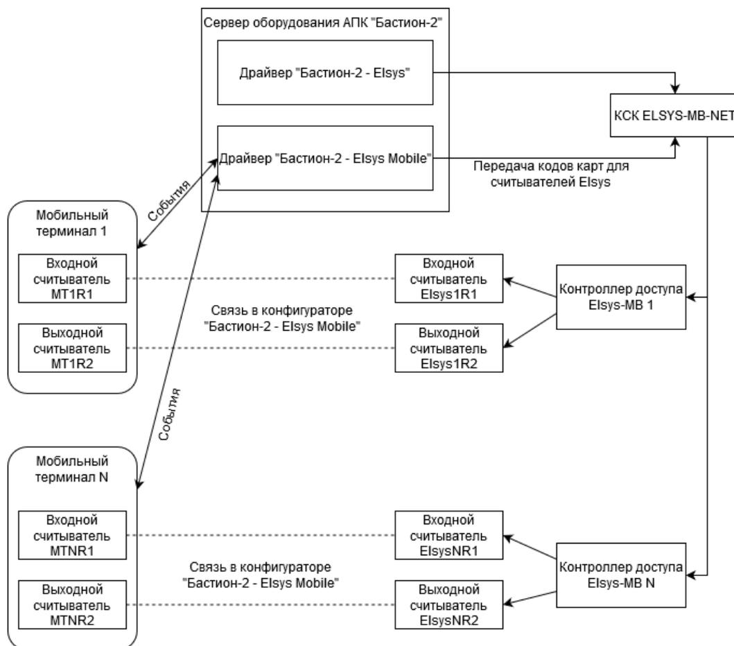
Рис. 1. Использование мобильного устройства в качестве считывателя карт доступа
